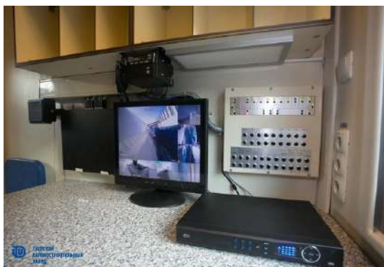
Рисунок 1.15 - Система видеонаблюдения в пассажирском вагоне, предназначенном для перевозки осужденных и лиц, находящихся под стражей модели 61-4495
