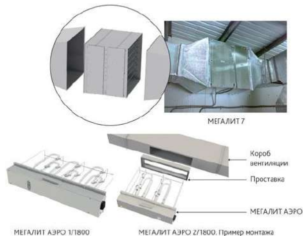
Рисунок 2.3–Схема подсоединения УФ-модуля и ячейки к воздуховоду вентиляционной системы и общий вид установок [32]
